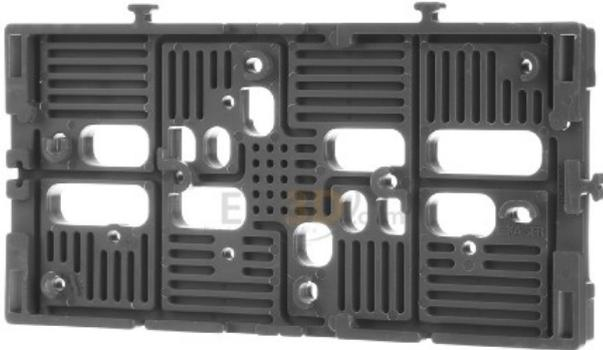
Montageplatte 2000-00 Geeignet für Einbaudose, Geeignet für Zentraldose, Art des Zubehörs sonstige, Befestigungsfläche 90 x 180 mm, über 200 Befestigungsmöglichkeiten für Geräte, problemloses Anreihen zu größeren Flächen durch angespritzte Verbinder, Montageplatte in zwei gleiche Hälften teilbar, Befestigung an Kabelbahnen, Rund- oder Vierkantrohren, TS 35 Normprofilen usw.
