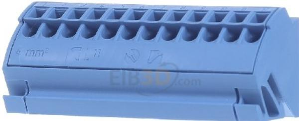
Sammelschienenblock 4qmm blau 812-104 Sammelschienenendicke 3 ... 3mm, Sammelschienenbreite 10 ... 10mm, Geeignet für Flachschiene, Breite der Klemme 75mm, Max. Leiterquerschnitt 4mm<sup>2</sup>, Max. Bemessungsbetriebsstrom Ie 96A, Geeignet für Rundleiteranschluss, Anschlussblock für Sammelschienen 10 x 3 12-polig ohne Drücker 4 mm<sup>2</sup>
