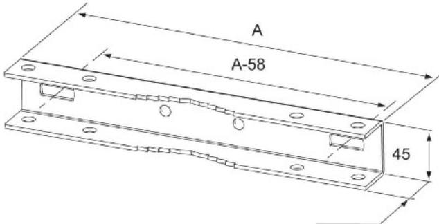
Mastbefestigung 300mm NSYSFPSC30 Art des Zubehörs Montagesäule/-pfosten, Werkstoff Stahl, Breite 295mm, Höhe 45mm, Tiefe 32,5mm, Mastbefestigung WM Special, Länge 300, für Mast max. 675, max. Last: 100kg
