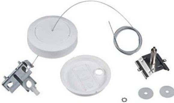
Seilabhänger m.Baldachin L2m D1,5mm 12kg 5TR901312 Art des Zubehörs sonstige, Farbe ohne, Werkstoff Stahl, Modario IP20/IP40/IP64, Einseil-Abhänger, mit ohne Klemme, Deckenbefestigungselement, aus Stahlblech, verzinkt, Baldachin, rund, aus Kunststoff, Seil, aus Stahl, verzinkt, Länge: 2.000 mm, Durchmesser: 1,2 mm, Abhängehöhe: bis zu 2,0m, Traglast (Abhängung): Tragkraft 12kg, Befestigungsbügel, aus Federstahl, glänzend, Verpackungseinheit: 1 Stück
