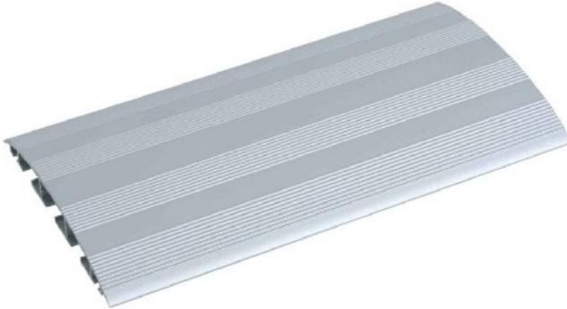
Kabelkanal alu 1,0m, gerade 930.060 Höhe 17mm, Breite 146mm, Länge 1000mm, Werkstoff sonstige, Werkstoffgüte sonstige, Farbe Silber, Anzahl der festen Trennwände 3, Befestigungsart selbstklebend und Bodenlochung, Kabelkanal aus eloxiertem ALU - Profil Länge: 1,0m mit Riffel - Struktur für ausreichende Rutschfestigkeit. 3 Kammer - System für die getrennte Verlegung von Strom- und Datenkabel Abmessungen: B x H = 146 x 19 mm verpackt im Polybeutel
