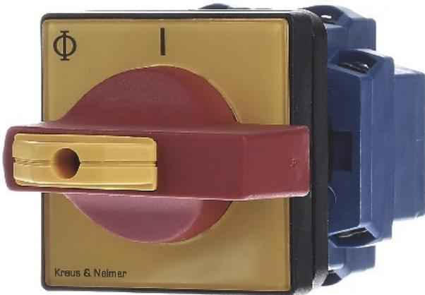
Hauptschalter Not-Aus KG10A T203/04E Ausführung Ein-/Ausschalter, Polzahl 3, Mit Nullstellung, Bemessungsdauerstrom I<sub>n</sub> 20A, Bemessungsbetriebsleistung bei AC-3, 400 V 5,5kW, Schutzart (IP), frontseitig IP66, Anzahl der Hilfskontakte als Öffner 0, Anzahl der Hilfskontakte als Schließer 0, Anzahl der Hilfskontakte als Wechsler 0, Geeignet für Frontbefestigung, Ausführung des Betätigungselements kurzer Drehgriff, Anschlussart Hauptstromkreis Schraubanschluss
