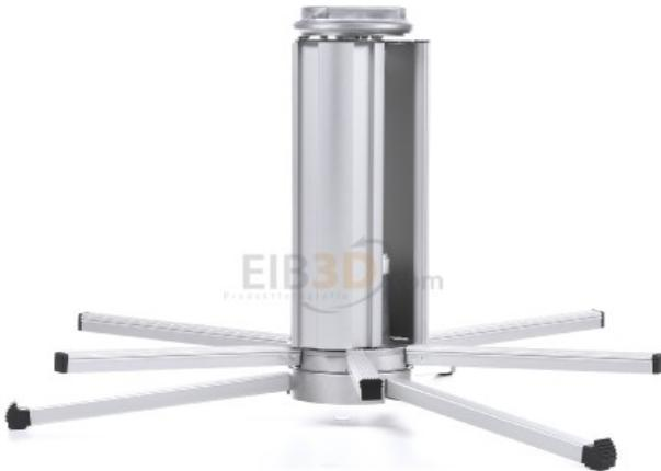
Kabelring-Abwickler Roll..Profi VarioClou Max. Kabelring-Innendurchmesser 260 ... 260mm, Max. Kabelring-Außendurchmesser 150 ... 750mm, Tragkraft 80kg, Für alle großen Leerrohr- und Kabelringe, Arbeitsfläche 750 mm, Kernhöhe 350 mm, zusammenklappbar
