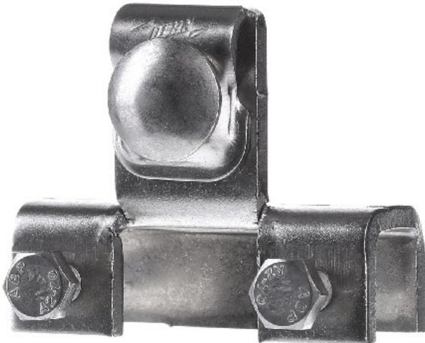
Anschlussklemme Niro senk. f.Profile 5-18 372 119 Art des Verbinders Anschlussklemme, Geeignet für Rundleiterdurchmesser 6 ... 10mm, Klemmbereich 3 ... 18mm, Werkstoff rostfreier Stahl (V2A), Oberfläche unbehandelt, Art der Befestigungsschrauben Sechskantschraube, Anschlussklemme für Stahlträger nach DIN EN 62561-1, für den Anschluss an Stahlkonstruktionen. Ausführung senkrecht mit Klemmbock, Anschluss längs oder quer.
