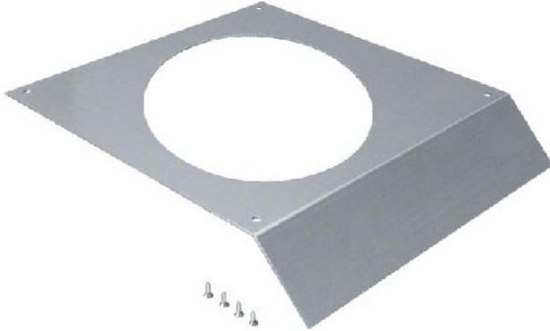
Abdeckung R12, rund, 306mm AKM400306R12 Ausführung Deckel einseitig abgeschrägt, Funktion Standard, Breite 400mm, Höhe 70mm, Länge 400mm, Montageöffnung rund, Anzahl der Montageöffnungen 1, Werkstoff Stahl, Abdeckung gestanz R12 rund 306mm Länge 400mm aus Stahlblech zu AK 400x70mm. Abdeckung mit Montageöffnung für Aufboden Installationskanäle nach DIN EN 50085-1 und DIN EN 50085-2-2, inklusive Befestigungsschrauben.
