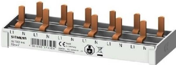
Anzahl der Phasen 1, Polzahl 1, Geeignet für Anzahl Geräte 6, Teilungsmaß 18 mm, Querschnitt 10 mm<sup>2</sup>, Länge 112,2 mm, Breite in Teilungseinheiten 6, Bemessungsdauerstrom Iu 63 A, Ausführung des elektrischen Anschlusses Stift, Isoliert ja, Max. Bemessungsbetriebsspannung Ue 230 V, Geeignet für Geräte mit N-Leiter ja, Geeignet für Geräte mit Hilfsschalter nein
