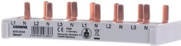
Anzahl der Phasen 3, Polzahl 3, Geeignet für Anzahl Geräte 6, Teilungsmaß 18 mm, Querschnitt 10 mm<sup>2</sup>, Länge 112,2 mm, Breite in Teilungseinheiten 6, Bemessungsdauerstrom Iu 63 A, Ausführung des elektrischen Anschlusses Stift, Isoliert ja, Max. Bemessungsbetriebsspannung Ue 230 V, Geeignet für Geräte mit N-Leiter ja, Geeignet für Geräte mit Hilfsschalter nein
