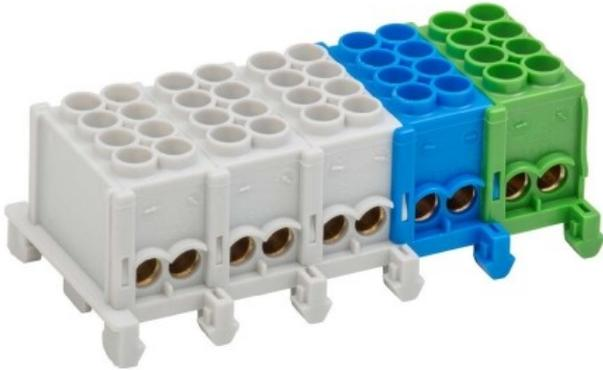
Polzahl 5, Nennstrom 63 A, Anschlussart schrauben, Montageart DIN-Schiene, Anzahl der Eingänge 5, Anzahl der Ausgänge 5, Geeignet für massive Leiter ja, Geeignet für mehrdrähtige Leiter ja, Geeignet für feindrähtige Leiter ja, Geeignet für feinstdrähtige Leiter nein, Leiterquerschnitt Zugang 25 mm<sup>2</sup>, Leiterquerschnitt Abgang 25 mm<sup>2</sup>, Berührungssicher ja, Höhe 80 mm, Breite 56 mm, Tiefe 45 mm
