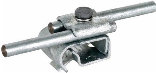
Dachrinnenklemme St/tZn f.Wulst 16-22 339 050 Art des Verbinders Dachrinnenklemme, Geeignet für Rundleiterdurchmesser 8 ... 10mm, Klemmbereich 16 ... 22mm, Werkstoff Stahl, Oberfläche tauchfeuerverzinkt, Art der Befestigungsschrauben Sechskantschraube, Dachrinnenklemme nach DIN EN 62561-1, zum Verbinden von Rundleitern dem Wulst der Dachrinne. Ausführung mit Doppelüberleger, Leitungsführung längs oder quer.
