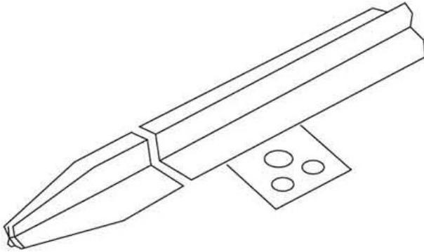
Staberder 1,5m lang 313/15 Ausführung mit Anschlusslasche, Durchmesser 13mm, Kreuzprofil, Verbindungsart sonstige, Länge 1500mm, Werkstoff Stahl, Oberfläche tauchfeuerverzinkt, Staberder aus Kreuz-Profil 50 x 50 x 3 mm aus Flußstahl
