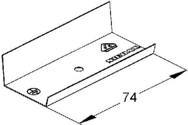
Stoßstellenverbinder LST 26.030 Breite des Leitungsführungskanals 26mm, Höhe des Leitungsführungskanals 30mm, Bauform sonstige, Werkstoff sonstige, Werkstoffgüte sonstige, Halogenfrei, Geeignet für Funktionserhalt, Bedarf: 1 Stück je Stoßstelle. Die Stoßstellenverbinder verbinden die Kanalunterteile elektrisch und mechanisch in einem Arbeitsgang.
