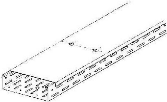
Kabelrinnendeckel m. Drehriegel RDV 100 Deckelbreite 102mm, Materialstärke 0,75mm, Geeignet für Kabelrinne, Geeignet für Kabelleiter, Länge 3000mm, Befestigungsart Drehriegel, Geeignet für Funktionserhalt, Werkstoff Stahl, Werkstoffgüte sonstige, Oberfläche bandverzinkt, Farbe ohne, Mit Drehriegelverschluss, Lieferlänge 3 m
