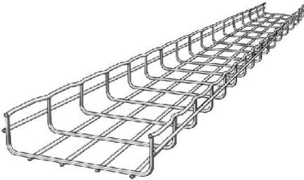
Schwerlastgitterrinne B=200mm H=54mm CF 54/200 V2A Profilform U-Form, Höhe 54mm, Breite 200mm, Drahtdurchmesser 4,4mm, Länge 3000mm, Nutzbarer Querschnitt 10800mm<sup>2</sup>, Ausführung ohne Verbinder, Schraublose Verbinder, Integrierte Trennwand ohne, Werkstoff rostfreier Stahl, Rostfreier Stahl, gebeizt, Werkstoffgüte sonstige, Oberfläche sonstige, Farbe natur
