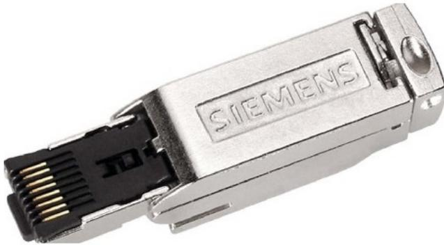
Steckverbinder 4x2, RJ45 6GK1901-1BB12-2AA0 Breite 13,7mm, Höhe 16mm, Tiefe 55mm, Umgebungstemperatur -40 ... 85°C, Werkstoff des Gehäuses sonstige, Art der Verriegelung sonstige, Betriebstemperatur -40 ... 85°C, Schutzart (IP), montiert IP20, Industrial Ethernet FastConnect RJ45 Plug 180 4x 2, RJ45 Steckverbinder CAT6A (10/100/1000/10000 Mbit/s) mit robustem Metallgehäuse und FC-Anschlussstechnik, für IE FC Cable 4x 2 (AWG24) 180° Kabelabgang 1 Packung=1 Stück IE FC RJ45 Plug 180 (4x2)
