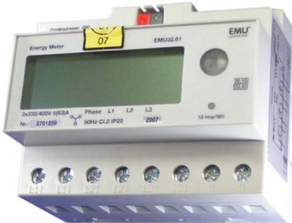
Stromzähler Hutschiene, Zwischenzähler, elektronischer Drehstromzähler für DIN-Schienen-Montage 3x230/400V; 5(63)A; 50/60 Hz; Einbaubreite 6 TE (107mm); Klasse 2; mit M-Bus-Modul nach DIN1434-3 und S0-Schnittstelle 1.000 Imp./kWh; Eigenverbrauch < 0,8W; Displayanzeige 00000,0 kWh; Temperaturbereich -10°C...+50°C; LxBxH 91mmx107mmx71mm; ungeeicht, Berücksichtigung der Oberwellen bis zur 9.harmon. Oberwelle, für Wechselrichter (PHOTOVOLTAIK) geeignet
