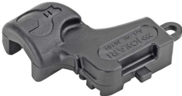
Steckschlüssel SW11 zu 120027 12 2127 Steckschlüssel SW 11 Zubehörteil, Aus hochsteifem, glasfaserverstärktem Kunststoff. Zum Festziehen von F-Steckern (HEX 11). Zum Nachrüsten des Kabelentmantlers COAXI
