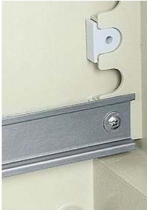
DIN Schiene symetrisch, 35mm NSYCS400PLM Ausführung Hutschiene 35/7,5 mm, Werkstoff Stahl, Ausführung der Oberfläche verzinkt, Lochform ohne, Materialstärke 1mm, Länge 380mm, Höhe 7,5mm, Thalassa PLM 35mm symmetrische DIN-Schiene, 2 Stk. L 380 mm. Zur Verwendung mit NSYTCSxx in PLM54 und 64. Befestigung über Aufnahmen für Kunststoffmuttern an der innenliegenden Rücksteite des Gehäuses. Höhenverstellung der DIN-Schiene über Umsetzen der Kunststoffmuttern, Teilung 25 mm. Aus Stahl, verzinkt.
