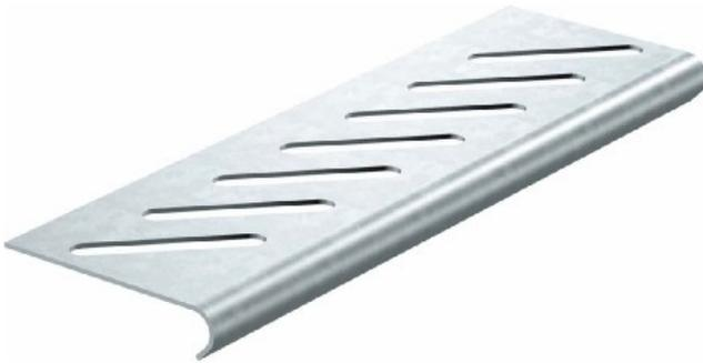
Bodenendblech f. Kabelrinne B150mm BEB 150 DD Kabelrinnenbreite 150mm, Werkstoff Stahl, Oberfläche bandverzinkt Zink-Aluminium, Farbe ohne, Das Bodenendblech wird an Enden von Kabelrinnen und Weitspannkabelrinnen verschraubt, um die Beschädigung von Kabeln, die dort austreten, zu verhindern. Die Stabilität der Kabelrinnen wird durch das Einsetzen des Bodenendblechs erhöht. Die zur Befestigung des Bodenendblechs erforderlichen Flachrundschrauben Typ FRS B M6 x 12 mm sind separat zu bestellen.
