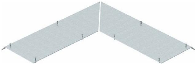
Außeneck-Blinddeckel Aufboden-Kanal AIKF AEA 25070 Ausführung Deckel einseitig abgeschrägt, Mit Überstand, Funktion Außeneck, Breite 250mm, Höhe 67mm, Länge 800mm, Montageöffnung ohne, Anzahl der Montageöffnungen 0, Werkstoff Stahl, Blinddeckel 2-teilig zum Abdecken des Außenecks eines Aufflurkanals, passend zu den Kanalunterteilen AIK/U. Die Deckelschräge überragt das Kanalunterteil im 45°-Winkel.
