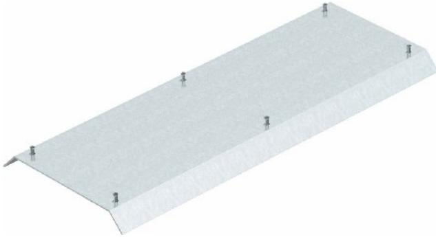
Blindabdeckung Aufboden-Abzweigek. AIKA D 25040 Ausführung Deckel beidseitig abgeschrägt, Mit Überstand, Funktion Abzweig, Breite 250mm, Höhe 37mm, Länge 800mm, Montageöffnung ohne, Anzahl der Montageöffnungen 0, Werkstoff Stahl, Aufflur-Blinddeckel zum Abdecken des Aufboden-Abzweigkanals AIK/A, passend zu den Kanalunterteilen AIK/U. Der Kanaldeckel wird in den AI-Seitenprofilen des Kanalunterteils festgeschraubt. Die Deckelschräge überragt das Kanalunterteil im 45°-Winkel.
