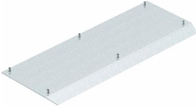
Blindabdeckung Aufboden-Abzweigek. AIKA AD 25040 Ausführung Deckel beidseitig abgeschrägt, Funktion sonstige, Breite 250mm, Höhe 37mm, Länge 800mm, Montageöffnung ohne, Anzahl der Montageöffnungen 0, Mit Anschlussöffnung, Werkstoff Stahl, Blinddeckel für Abzweigekanal AIKA/U zur Anpassung an die Ausstanzung des Blinddeckels AIKF/D-T inkl. 6 Befestigungsschrauben.
