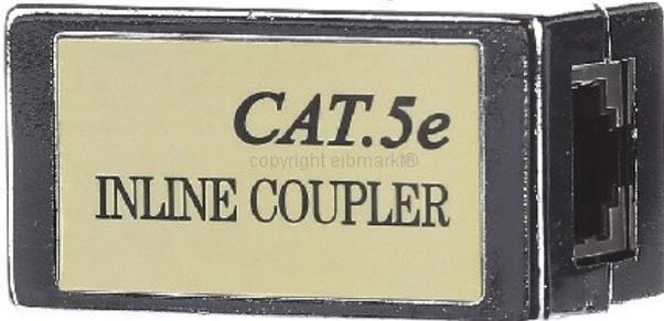
Modular-Kupplung 1:1 RJ45 Cat.5E 37529.1 Bauform gerade, Steckverbindertyp 2x RJ45, Geschirmt, Kategorie 5E, Ausführung Buchse/Buchse, Befestigungsart sonstige, Hochwertige Verbindungskupplung für Netzwerkabel. Adapter auch geeignet für ISDN Kabel. 2x RJ45 Buchsen geschirmt. Metallisierte Ausführung. Belegung 37529.1 1:1, 37529.2 Crossover.
