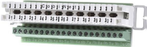
LSA-Trennleiste 2/10 SK zu 10 DA 1020 029 Ausführung Trennleiste, Anschlussart LSA-Plus, Einbaumöglichkeit für Überspannungsschutz, Mit Leistenmarkierung, Farbe weiß, Breite 129,5mm, Max. Anzahl der Doppeladern (DA) 10, Leiter-Durchmesser 2,5 ... 2,5mm, LSA-Trennleiste 2/10 SK zu 10 DA Schraubklemme einseitig für Montagewanne Schraubklemmen zum Anschluss von Adern mit Leiterquerschnitt bis 2,5 mm<sup>2</sup>
